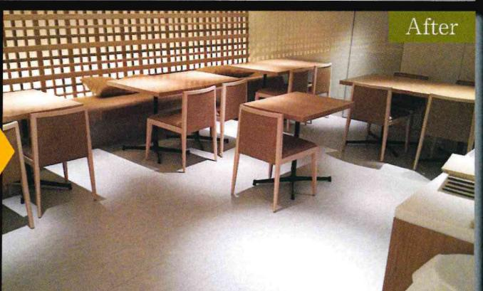
大勢の人の出入りがあり、スペリにくい凸凹のタイルを用いているので、飲食店やレストラン等の油や汚れがモップでは取れない状況となっていました。油汚れ等を完全に除去して、凸凹があっても掃除がしやすいガラス系の塗膜性コーティングで、汚れの付きにくい床を完成させています。
